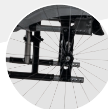
4 réglages du centre de gravité possibles
