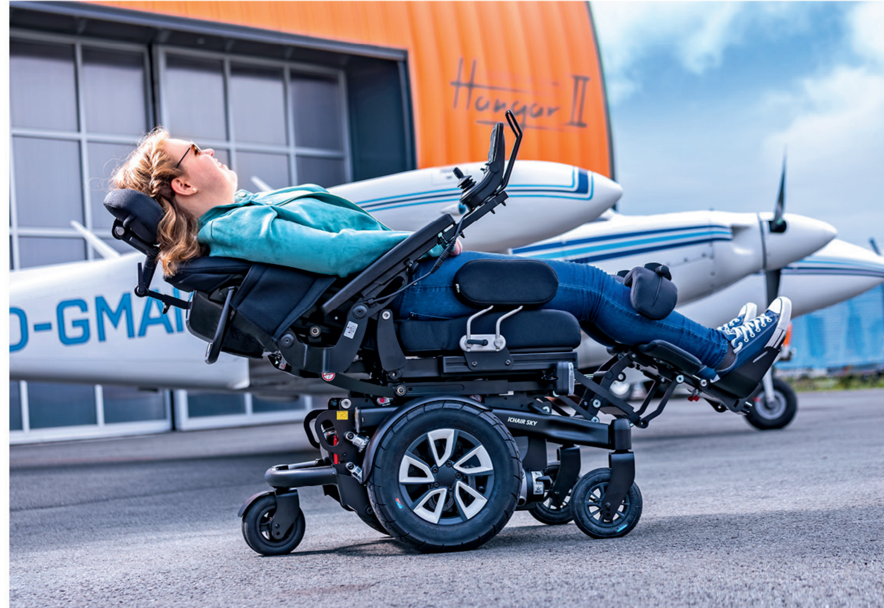
En option : la fonction de couchage avancée avec biomécanique pour accoudoirs et appui-tête améliore l'ergonomie en position couchée, en soutenant la tête et en rabattant les accoudoirs à 45°.
