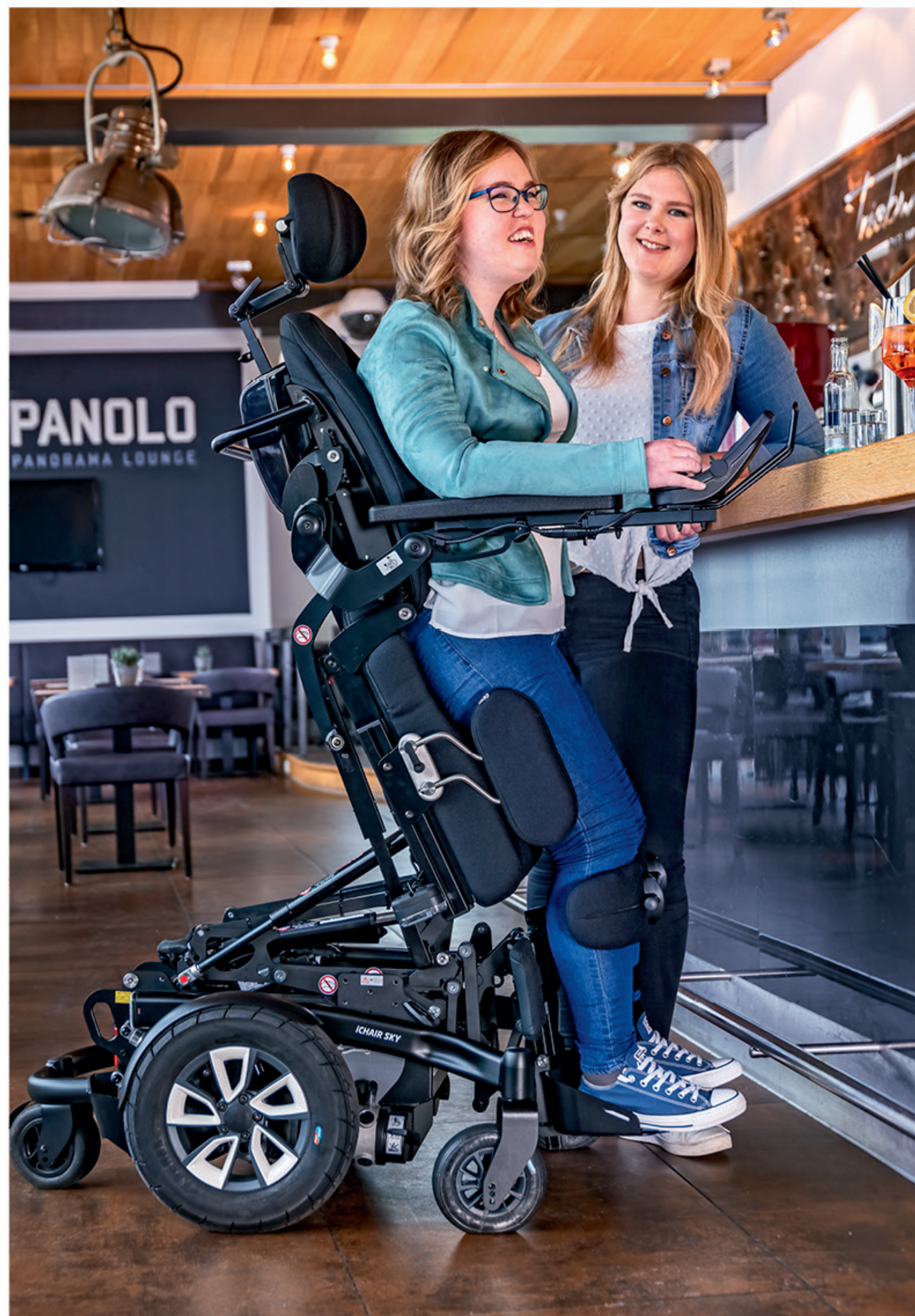
Grand angle de verticalisation jusqu'à 90°, sangle pectorale incluse, conduite debout (3 km/h), verticalisation possible à partir de chaque position
