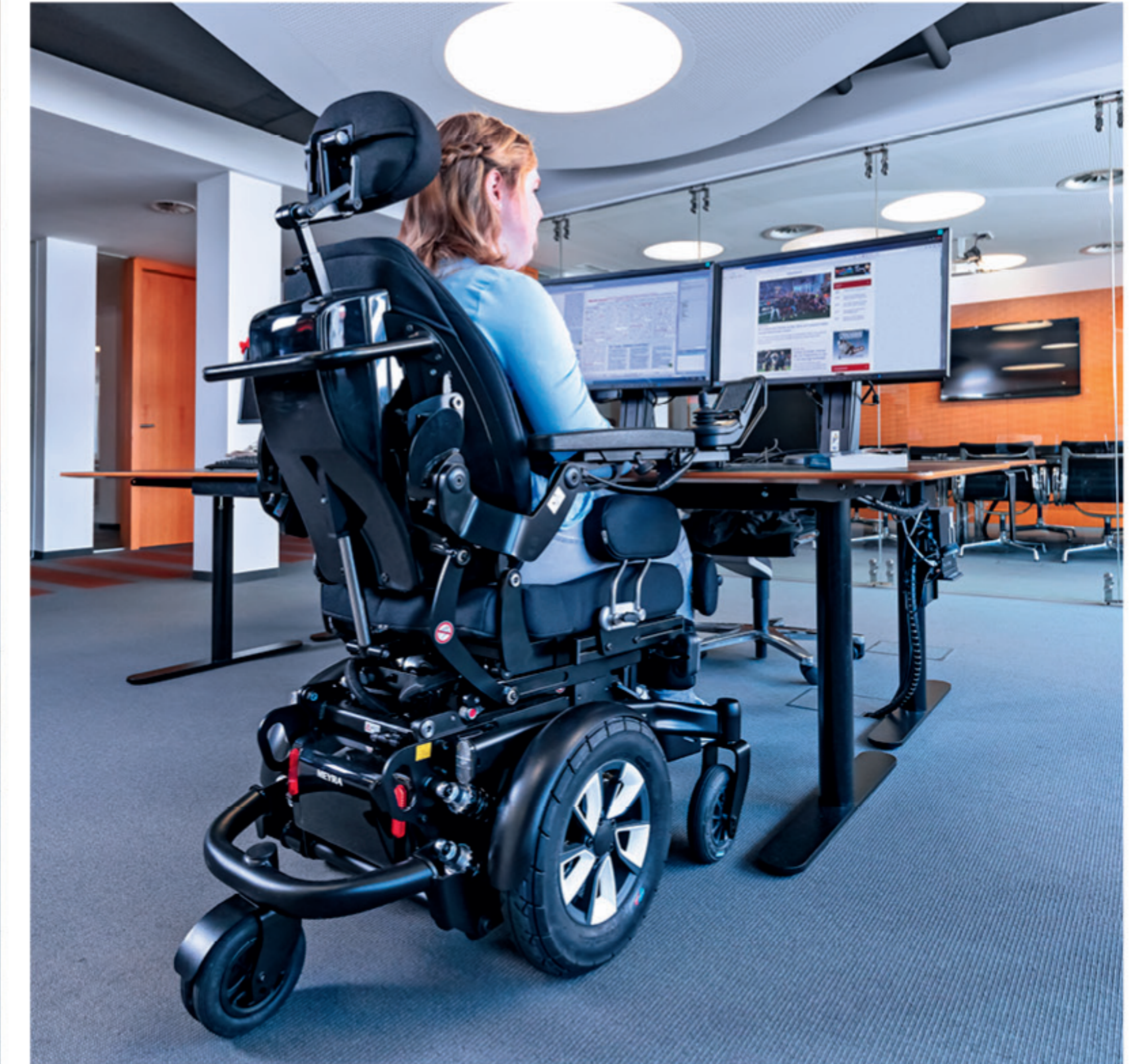
Roues motrices centrales avec roues directrices placées de façon idéale, hauteur d'assise et largeur totale réduites.
