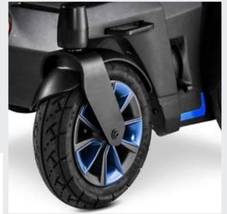
Die neuentwickelte Einzelradfederung (4-fach)
