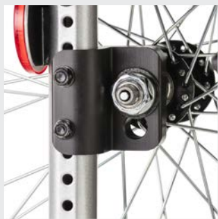
Wielbasisverlenging door naar achteren draaien van het varioblok
