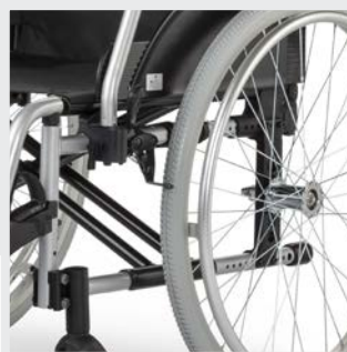
Verhoogde stabiliteit door een dubbele schaar
